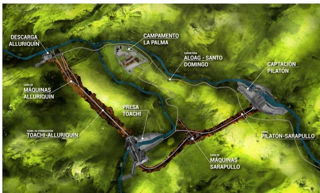
Diagrama Esquemático de la Estructura del Proyecto
